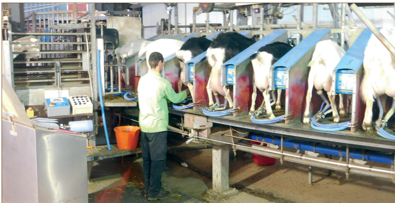
12. kép: 76 állásos fejő karusszel elektronikus beazonosítóval és abrak adagolóval
